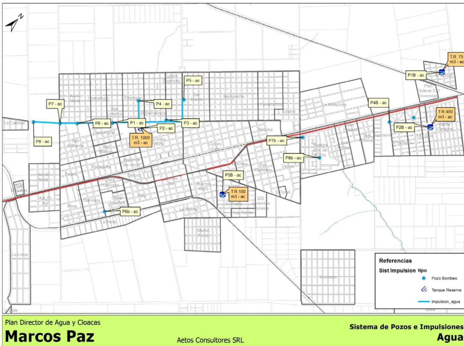
Figura 52: Sistema de provisión de agua potable (CFI)
